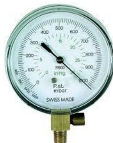
Ci sono poi i **manometri metallici**, come il manometro Bourdon (fig.12), che sfrutta la deformazione causata da una differenza di pressione su un tubo cavo a forma di anello. Una delle estremità del tubo è chiusa e collegata a un indice, l’altra è in comunicazione con il fluido. La differenza di pressione fra interno ed esterno del tubo fa spostare l’indice su una scala.
