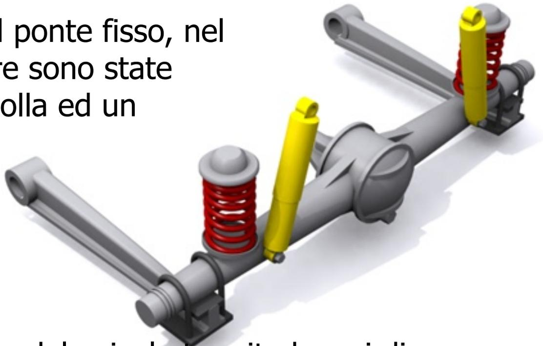
L'asse è unito al telaio del veicolo tramite bracci di accoppiamento. Le parti anteriori di questi sono fissate al telaio, le parti posteriori all'asse.
