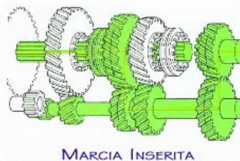
**Ogni rapporto è costituito da una coppia di ingranaggi innestati rispettivamente su secondario e ausiliario:** quando è in folle tutti gli ingranaggi del secondario sono “scollegati” dall'asse, quando inseriamo una marcia andiamo a inserire un supporto tronco-conico tra albero e ingranaggio. In tal modo diventano un tutt'uno e la coppia passa da primario all'ausiliario e da questo al secondario e quindi alle ruote motrici.
