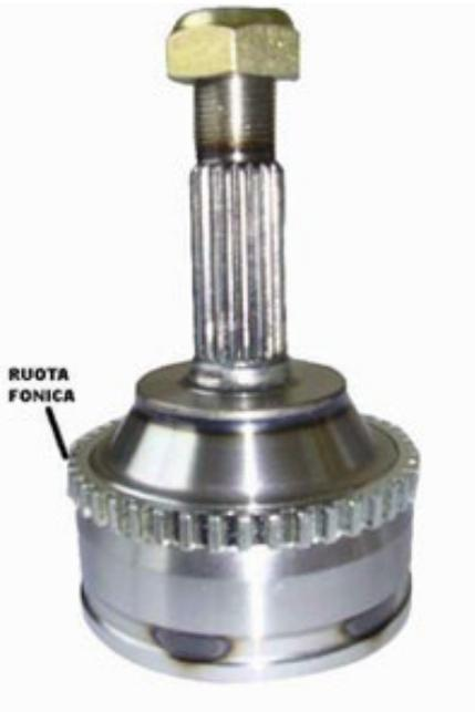
Innanzitutto l'**Abs** ha bisogno di sapere **se le ruote stanno girando o se una si sta fermando**. Ciò è reso possibile da un congegno particolare chiamato "**ruota fonica**", che nella ruota anteriore è montato direttamente sul mozzo, come quello in foto a fianco.
