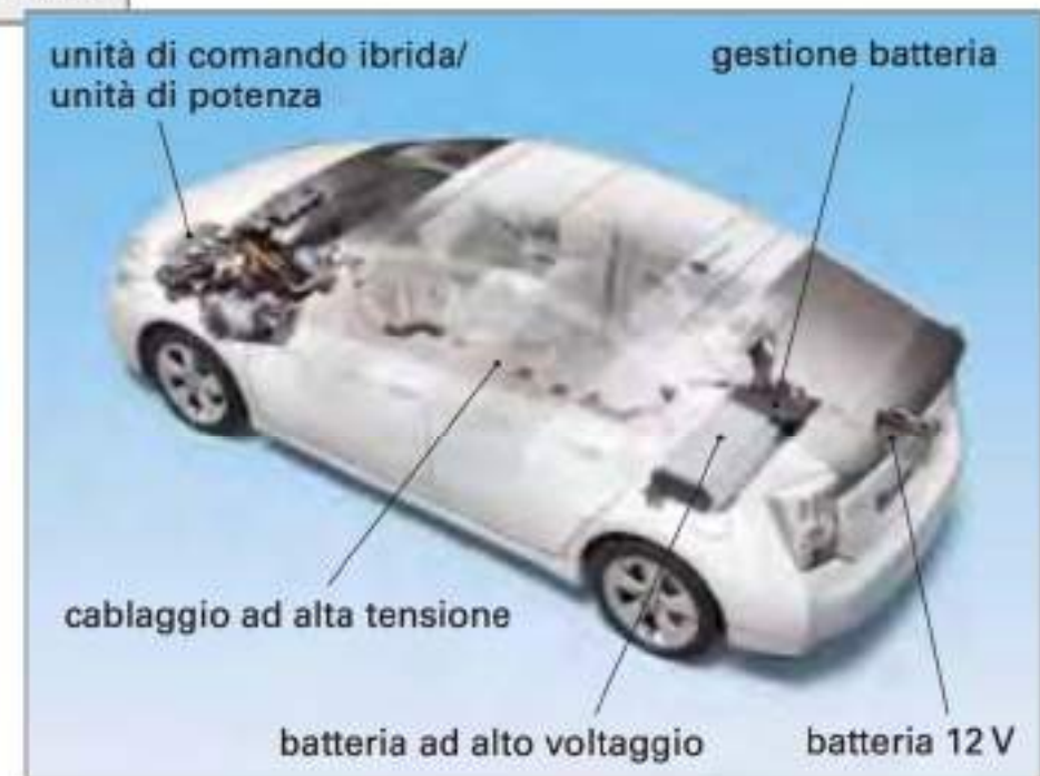
Figura 2: Componenti della trazione ibrida
