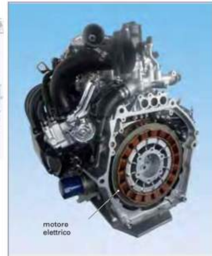
Figura 1: Sistema ibrido in parallelo
