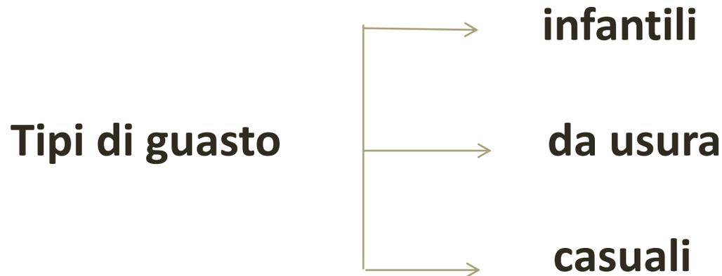
Quelli **infantili** si verificano nella prima parte della vita di un componente o di un impianto, sono dovuti a imprecisioni o errori di progetto, o a messa in opera imprecisa. Si possono eliminare spesso con un periodo di rodaggio.
