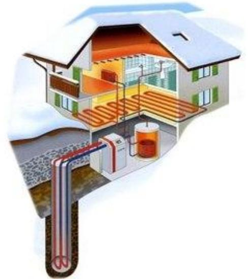
Durante l'inverno il terreno ha una temperatura generalmente superiore a quella esterna, il fluido glicolato scendendo in profondità attraverso le sonde sottrae energia termica al terreno; ritornato in superficie ad una temperatura maggiore, provoca l'evaporazione del refrigerante che circola nel sistema della pompa di calore, il liquido si espande ed assorbe calore dalla sorgente esterna, ovvero, tramite le sonde geotermiche, dal terreno.
