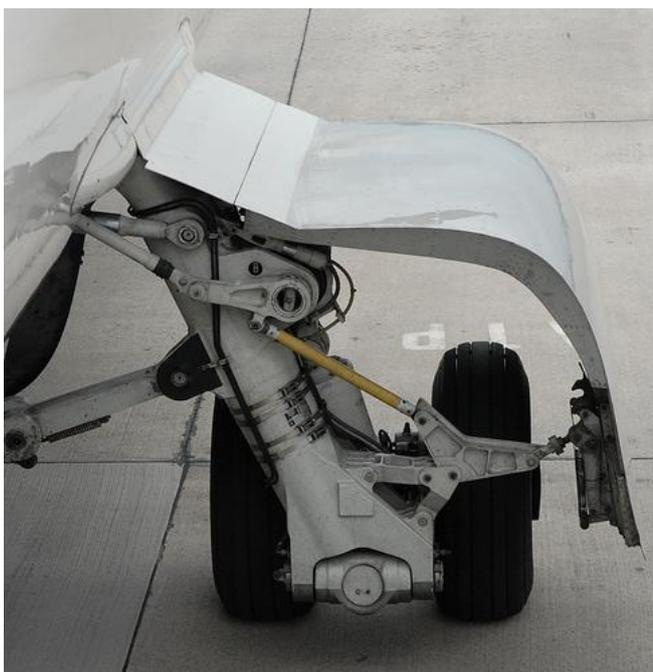
Gli interventi principali riguardano l'ingrassatura delle cerniere di perno, la verifica del pacco freni e ovviamente la sostituzione degli pneumatici; curiosamente per quest'ultima operazione si procede come per il cambio gomme di un'automobile. Le differenze sostanziali riguardano il *crick* che è a funzionamento pneumatico, il dado di serraggio del cerchione (come in Formula 1 si ha un solo elemento di fissaggio) e la relativa chiave dinamometrica lunga circa due metri.
