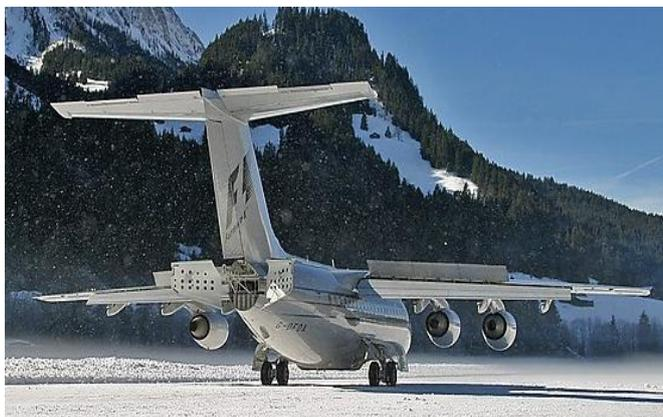
Discorso simile vale per gli air brake posizionate sulle ali (vedi immagine di lato) che servono per abbattere in misura drastica l’effetto portante delle ali una volta toccata la pista di atterraggio. Anche in questo caso i freni mobili sono azionati da pistoni idraulici ad elevata potenza.
