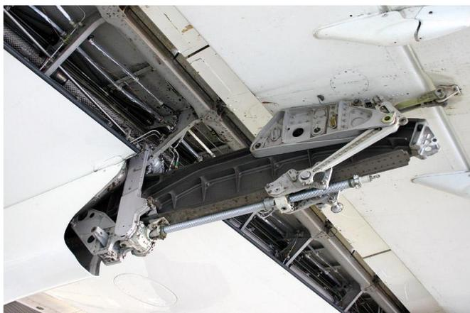
Il meccanismo che permette il movimento delle superfici è una vite senza fine azionata da un motore elettrico che, attraverso tutta una serie di alberi di trasmissione e di rinvii, assicura il posizionamento delle varie superfici alari; infatti si possono impostare dalla cabina di pilotaggio 5 configurazioni principali in funzione del tipo di pista a disposizione.
