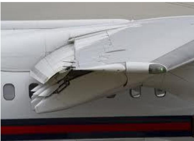
Nell’immagine qui accanto si può osservare il movimento dei *flaps* che “scivolano” verso il basso in fase di decollo e atterraggio e sono sistemati all’interno del profilo alare in fase di crociera. I movimenti delle superfici ovviamente devono essere simmetrici sulle delle ali per non creare uno squilibrio aerodinamico pericolosissimo.
